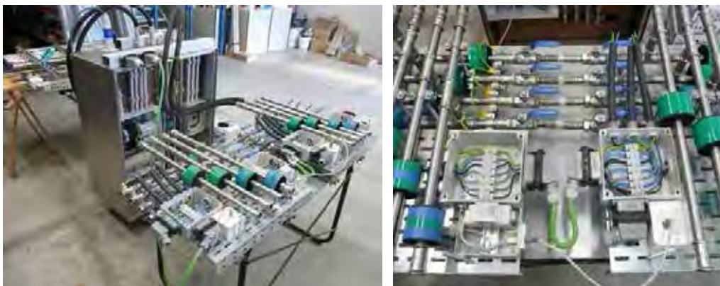
Figura 6. Módulos completos, con la red de doble anillo interior/externo, y equipos intermedios de conexión para cada módulo, así como entre cada módulo jurídico debe existir posibilidad de conexión.
