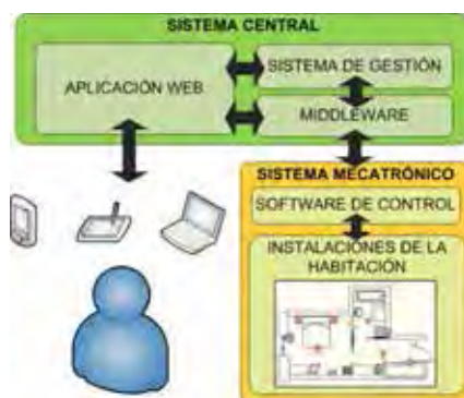
Figura 4. Esquema del Sistema de Inteligencia Ambiental (Fuente: creación propia)
