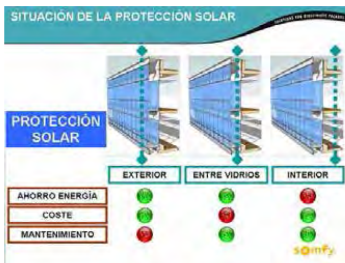
Figura 5: Situación de la Protección solar en la fachada.
