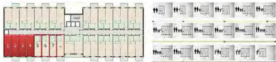
Figura 1. El esquema propuesto consiste en un corredor central que sirve a una serie de módulos legales independientes que permiten su adaptación espacial a las necesidades de las familias. La configuración espacial de los edificios es abierta, tanto en el momento de construirse como a lo largo de su vida útil.
